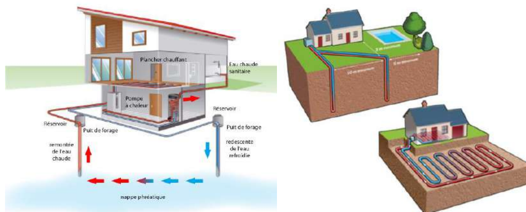
Figure 21 : Schéma de principe des différents types de géothermie de surface : géothermie sur aquifère ou géothermie sèche verticale ou horizontale.
